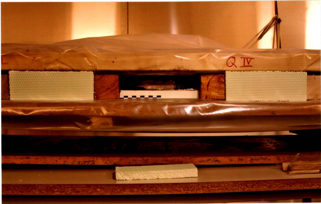
Abb.13 Verschließbare Kammervorrichtung bestückt mit auswechselbar Kühlzellen
