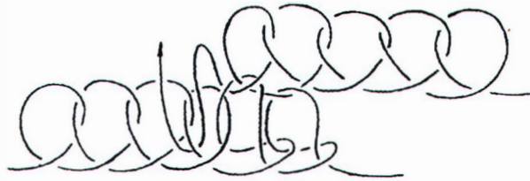
Abb.6b Durch das Anziehen des Fadens verformte Schlaufen
